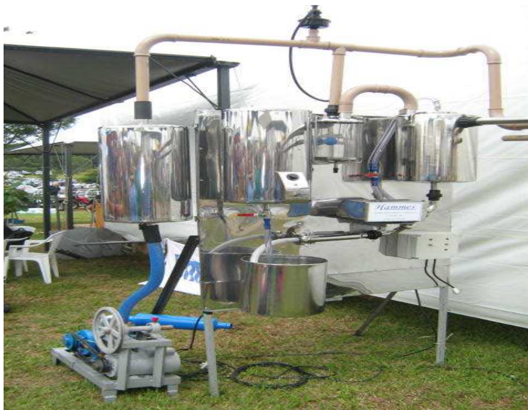
Ordeñadora múltiple: sistema de succión y enfriamiento. El accionamiento de la bomba es por sensores electrónicos. Posee limpieza automática.
